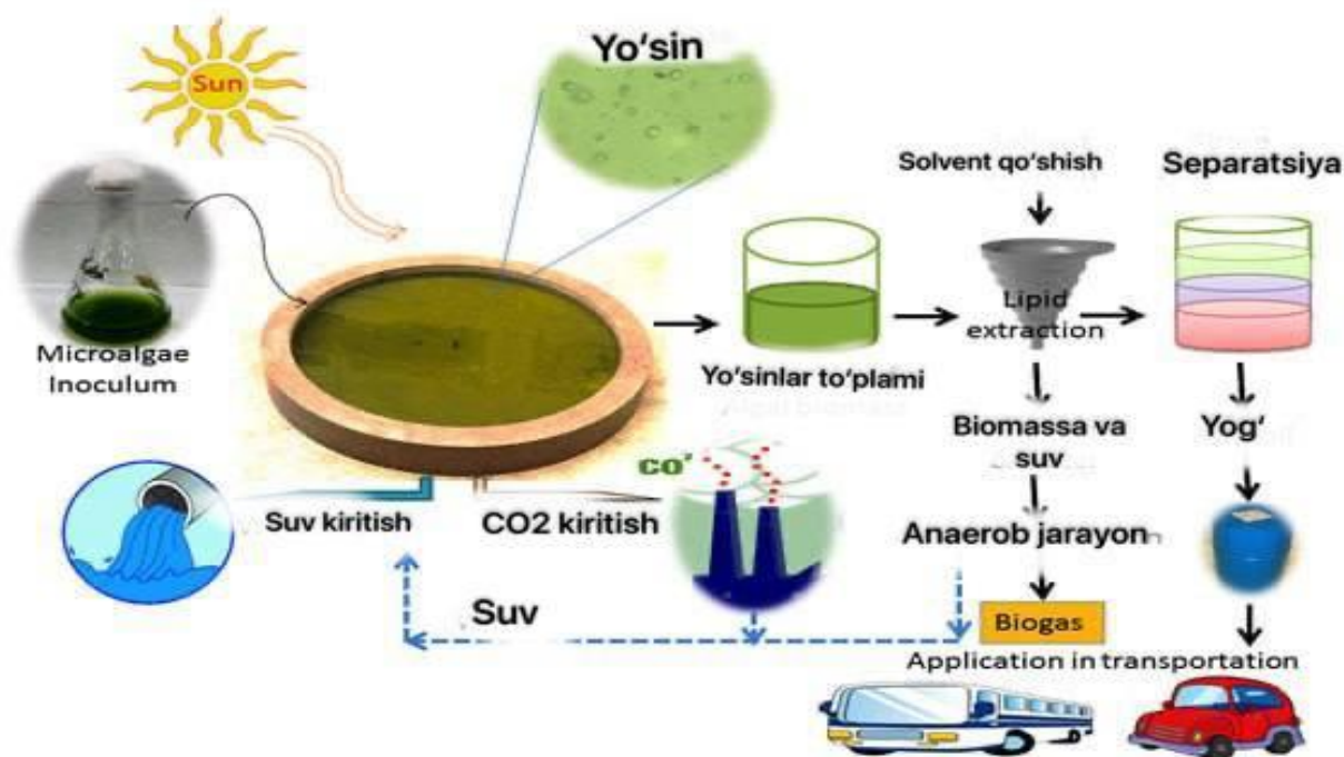
2-rasm: Yo'sinlardan biodizel ishlab chiqarish texnologiyasi
