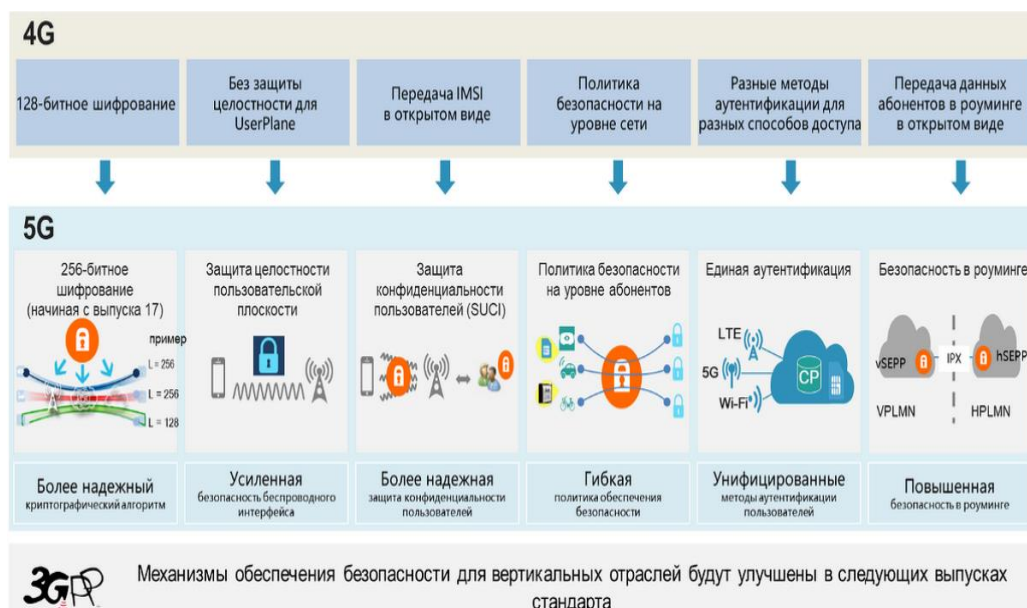
Рис. 1. Трансформация технологии 4G в 5G.
