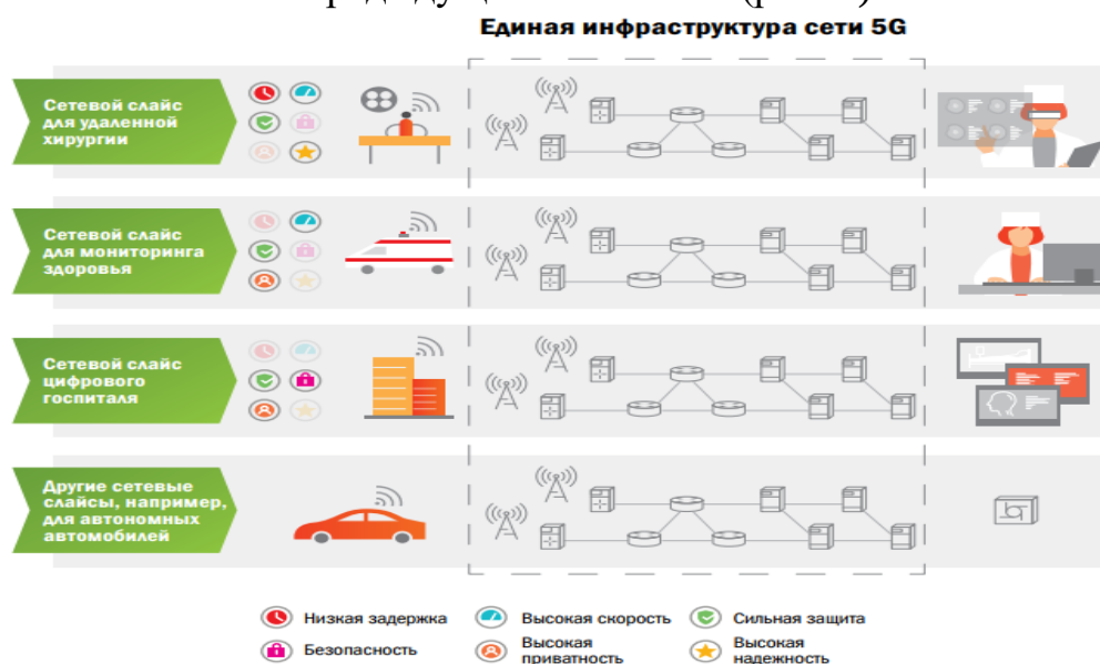
Рис. 2. Сетевые слайсы для различных функций и приложений в единой инфраструктуре сети 5G
