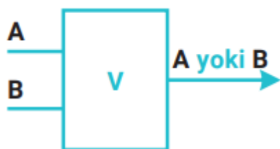
3-rasm. "YOKI" mantiqiy elementi
