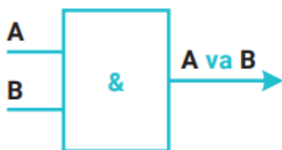
1-rasm. "VA" mantiqiy elementi
